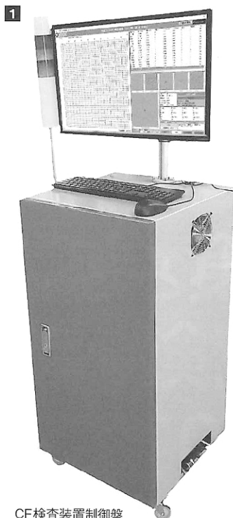
CF検査装置制御盤
