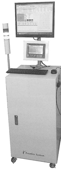
写真2 XGXM 検査装置小型制御盤
